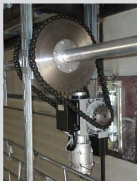
Particolare motore con rinvio a catena
