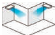
Installazione in base alla geometria della stanza
