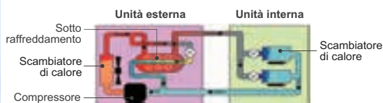
In caso di circuito di raffreddamento
